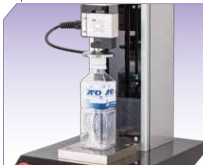
Испытание пластиковой тары на сопротивление сжатию
