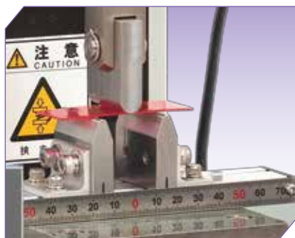
Испытание металлических пластин на изгиб
