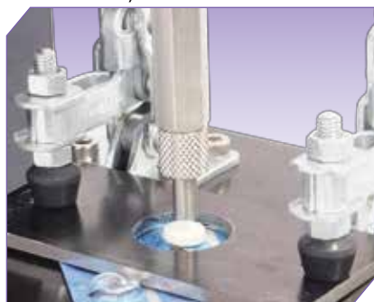
Испытание металлических пластин на изгиб
