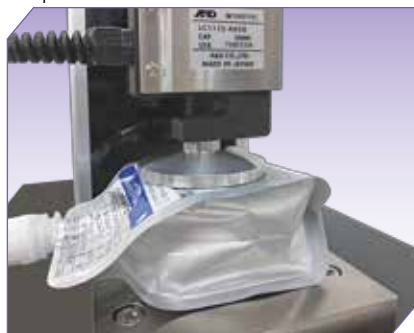
Испытания упаковочной тары на сопротивление сжатию
