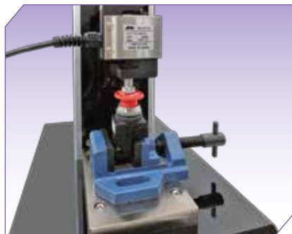
Испытания упаковочной тары на сопротивление сжатию
