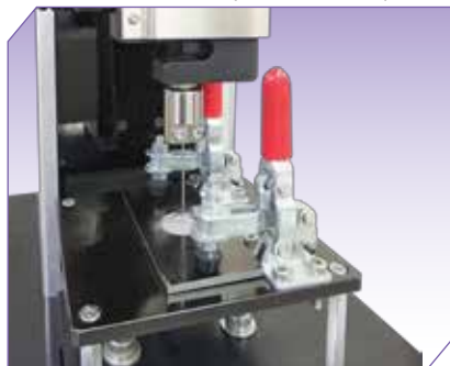
Измерение силы нажатия шприца
