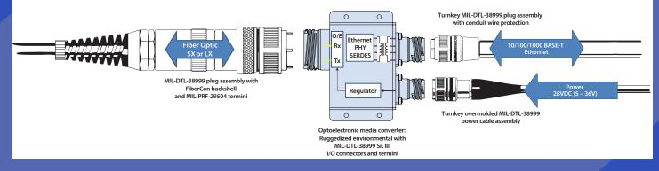
GLENAIR HIGH DENSITY (GHD) INTEGRATED OPTOELECTRONIC / FIBER OPTIC AGGREGATION SYSTEM
