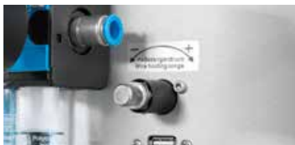
Отдельная регулировка усилия зажима провода
