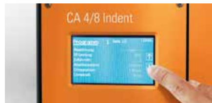
Автоматическая регулировка длины зачистки и глубины обжима
