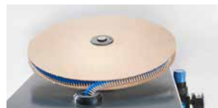
Обработка кабельных наконечников на катушке
