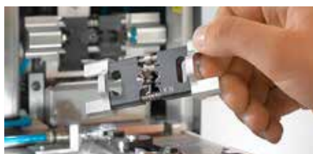
Быстросменный инструмент для быстрой переналадки
