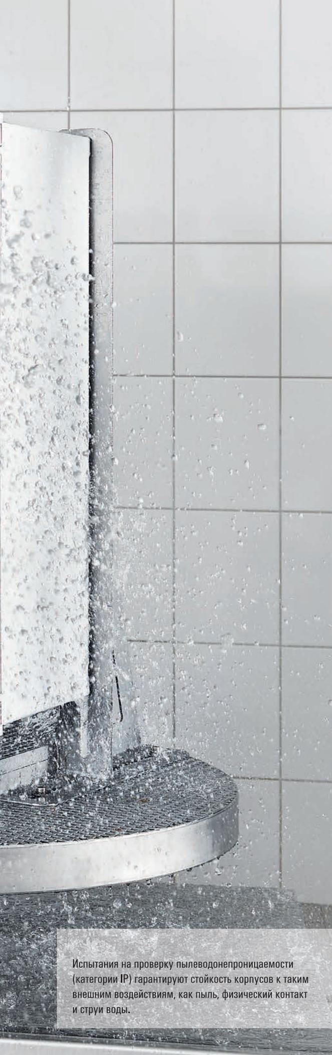
Испытания на проверку пылеводонепроницаемости (категории IP) гарантируют стойкость корпусов к таким внешним воздействиям, как пыль, физический контакт и струи воды.
